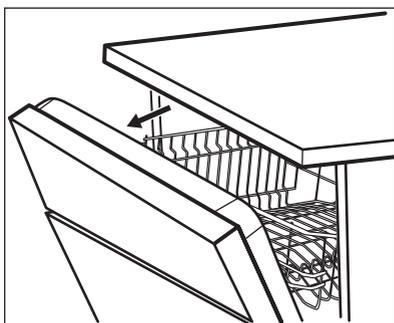
AirDry wird automatisch bei allen Programmen eingeschaltet.
