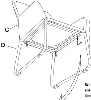
Schrauben nicht fest anziehen, bevor alle Schrauben eingesetzt sind!
