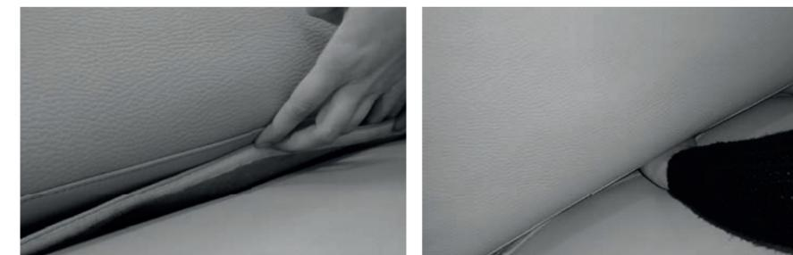
Abbildung 12: Bezugsstreifen mit Flauschband
