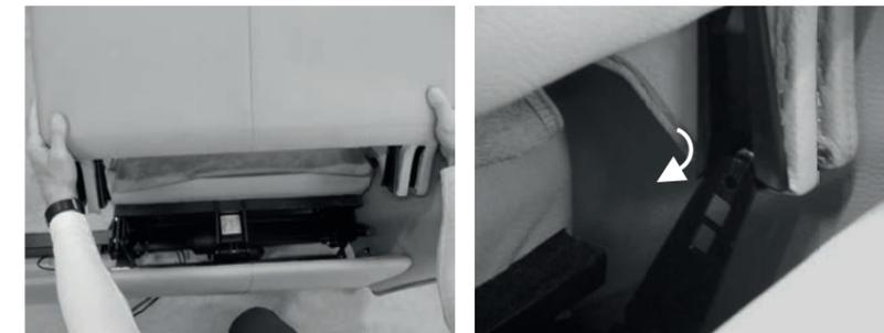
Abbildung 7: Aufsetzen Rückenbaugruppe
