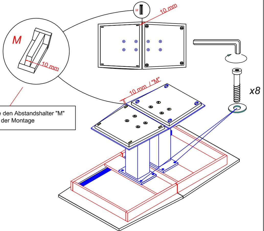
Bitte verwenden sie den Abstandshalter "M" zum Ausrichten bei der Montage
